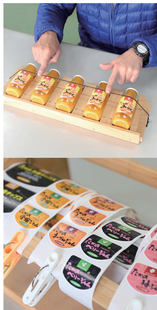
左：高所での作業や、細かい作業を必要とするみかん果実の二度切り（実から出た茎を根元で切る作業）も難しくなす。 右：従業員みんなで考えて製作した、ラベル貼りのための治具。ジュースやジャムなどのボトルへのラベル貼りを均一に、効率よく行うことができる。
