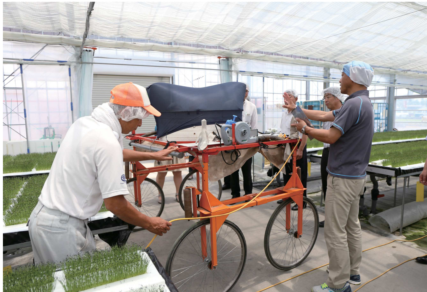
ハウス内の虫を吸いとる虫取り機。ゆっくりと障がいのある方のペースで動かすことで、効果を発揮する。
