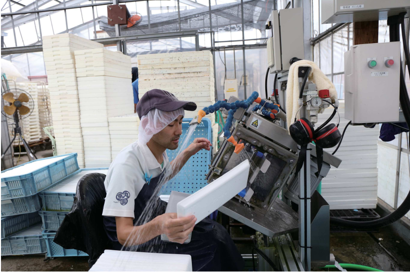
上：中にブラシを備えトレーを入れることで洗淨できるよう製作した機械 下：現在はさらに改良を加えたより効率的な洗淨機械も稼働している
